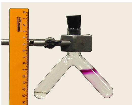
Рис. 1. Применение сосуда Ландольта в демонстрационных опытах по диффузии газов и жидкостей
